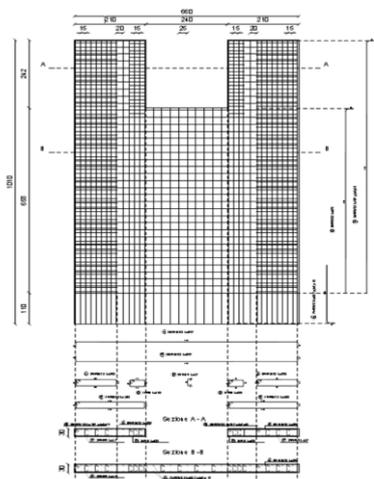
Distinta armature tipo e particolari costruttivi Autodesk Autocad 2017 Autocad Advanced Steel
